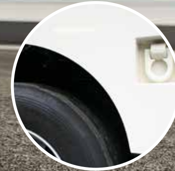
Wartungsarme Einzelaufhängung mit über 30 Jahren Erfahrung. Verzurrmöglichkeit für Fähr- oder Zugverladung
