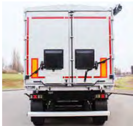
Hecktür mit hälftiger Flügelteilung und zwei Kornschiebern.
