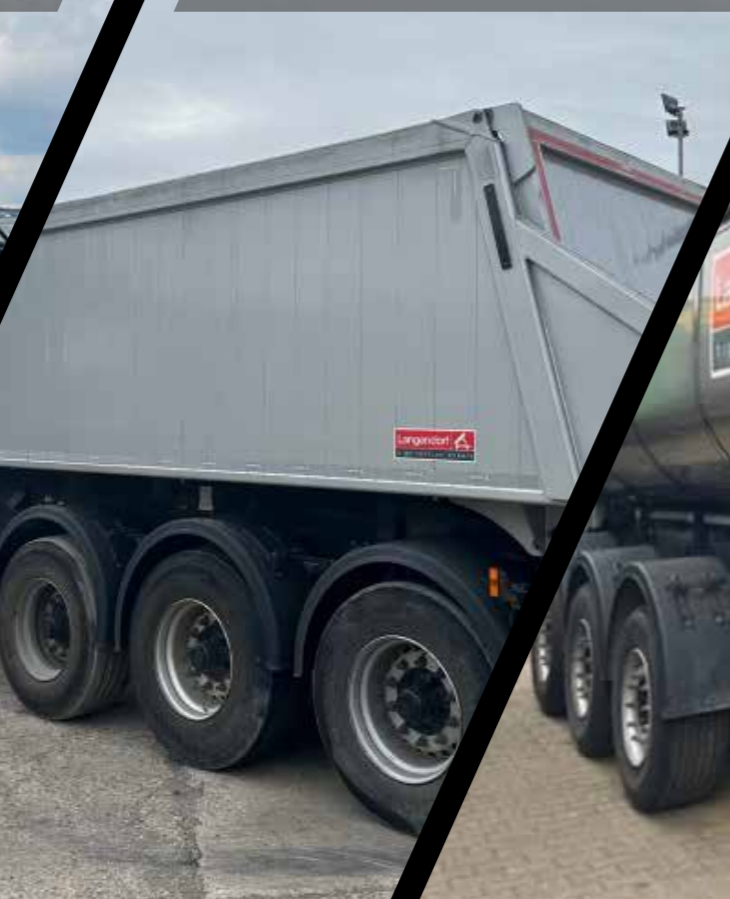
SKA 24/30 Langendorf Dreiachs-Kastenmulde Aluminium mit 27 m 3 Volumen
