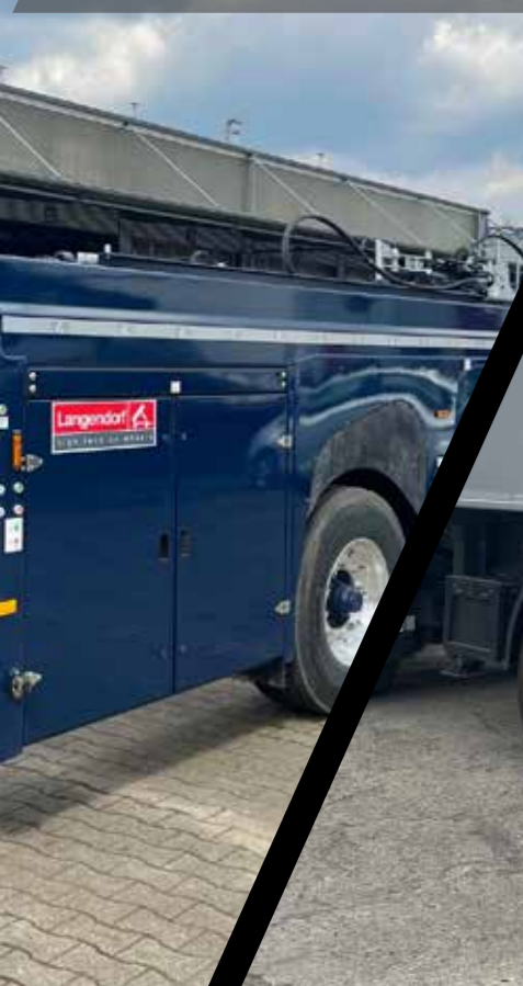
SBH 27/28 Langendorf Betoninnlader mit vollhydraulischer Federung und 6-Fach-Hydraulik-Verspannung
