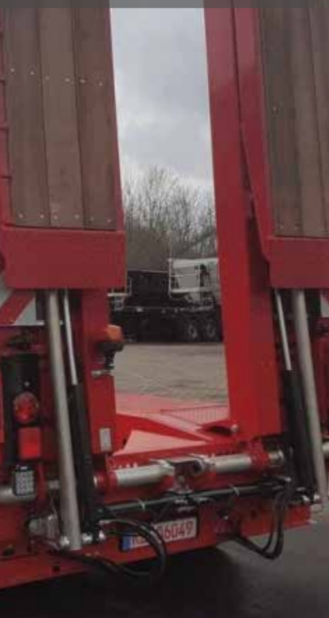
SATBÜ 30/48 Langendorf Tiefbett-Aufleger mit versenkbarem Einfahrkeil im Tiefbett
