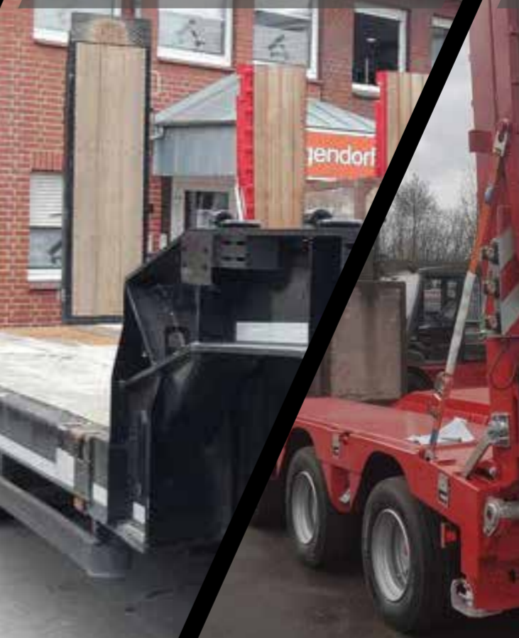
SATÜ 40/46 Langendorf Vierachs-Satteltieflader, 3. und 4. Achse nachlaufgelenkt, Rampe hydraulisch, SAF-Achsen
