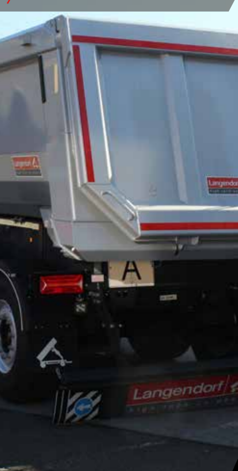
SKS-HS 24 Langendorf Dreiachs-Halbschalenmulde Stahl mit 25 m 3 Volumen
