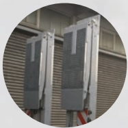
Doppelklappbare Rampen mit hydraulischer Spreizfunktion
