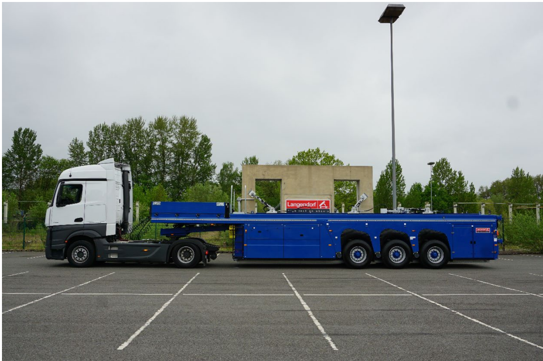
Bild 2: Der Betoninnenlader von Langendorf
