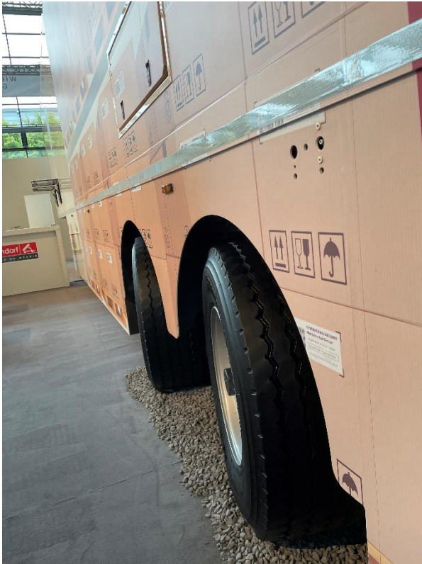
Bild 3: Die gelenkte Achse des Flexliners
