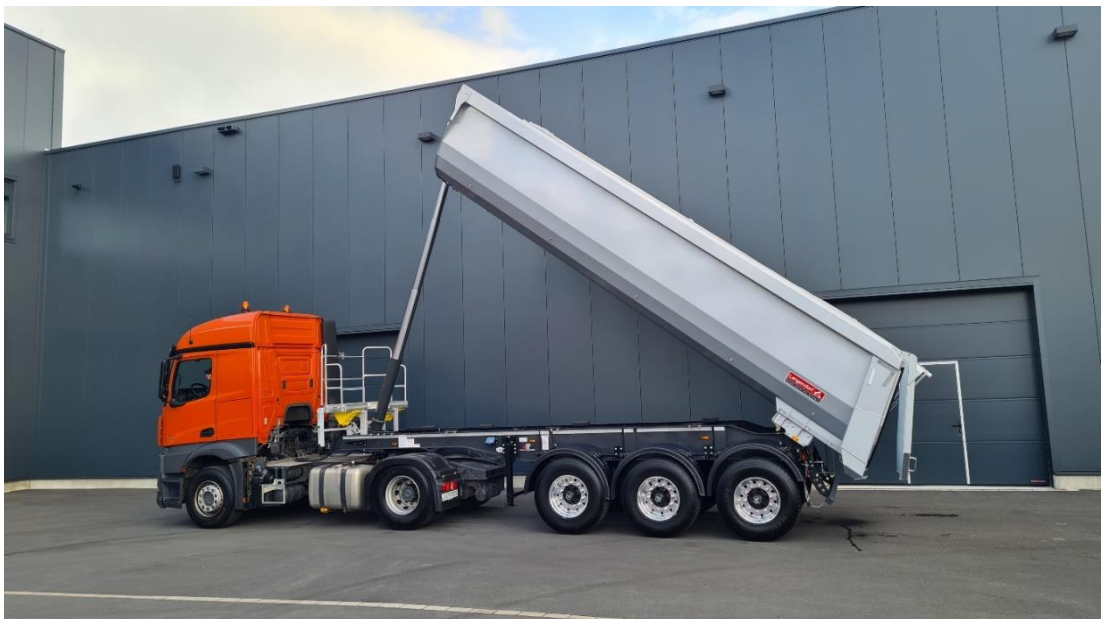
Bild 2: Die Aluminium Halbschalenmulde für den universellen Einsatz.
